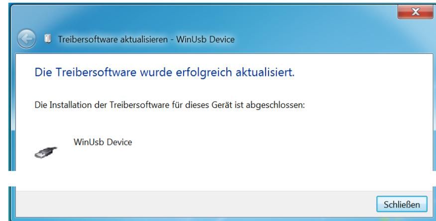
WaveR8 wird im Geräte-Manager fortan als **WinUsb Device** unter **Universal Serial Bus devices** angezeigt.
